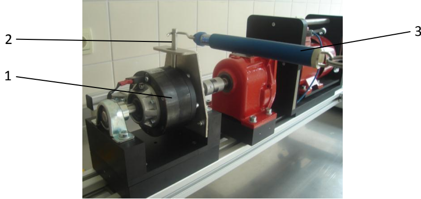
Şekil 12. Deney düzeneğinde frenleme(çıkış) momentinin belirlenmesi
